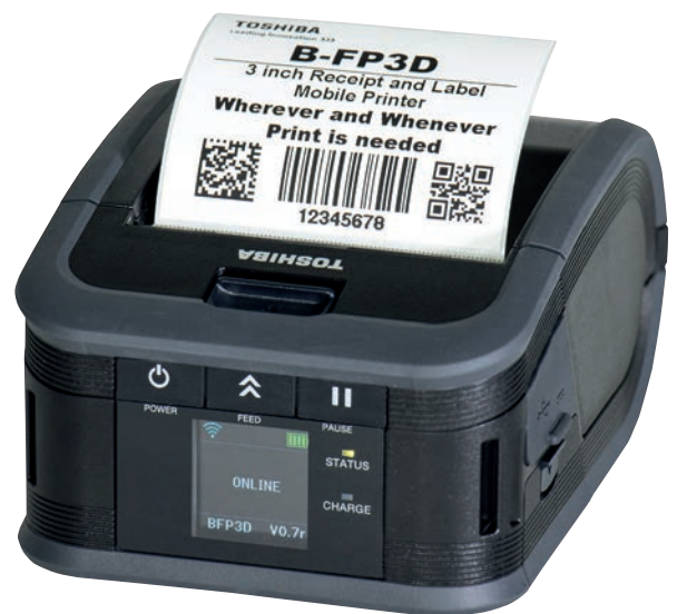
La B-FP3D incorpora una pantalla LCD gráfica a todo color para facilitar el uso y una mayor eficiencia.
